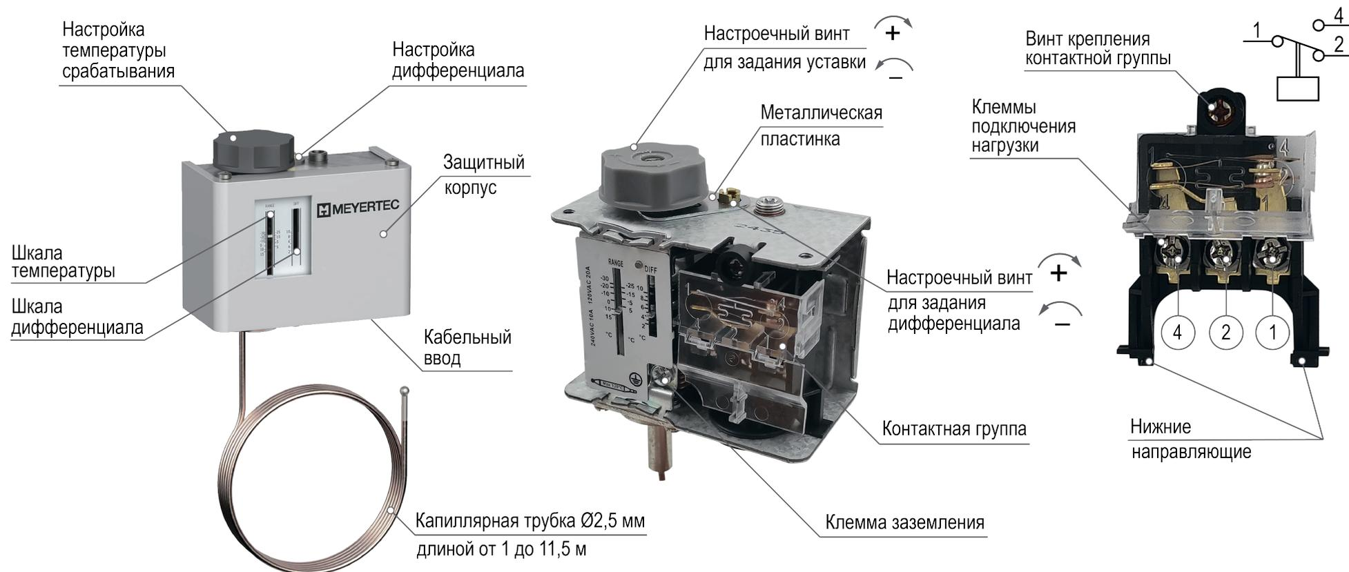
Рисунок 4.1 – Конструкция прибора
