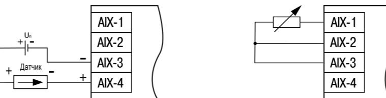
Рисунок 8 – Схема подключения датчиков с унифицированным выходным сигналом тока 4...20 мА по двухпроводной схеме
