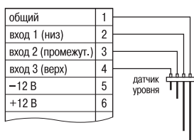
Подключение кондуктометрических датчиков уровня
