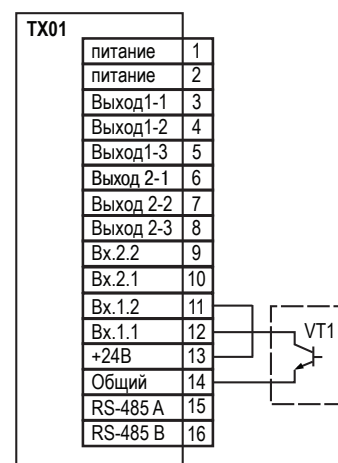
Подключение пассивных датчиков n-p-n-типа с открытым коллекторным входом при работе датчика от внутреннего источника питания
