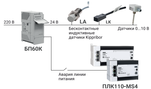
Сигнализация наличия питания для датчиков и актуаторов в ответственных применениях
